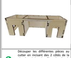
planche si besoin. Fixer les bords verticaux à la colle à bois en veillant à l'équerrage. Il n'y a qu'une seule possibilité de montage grace aux détrompeurs.
