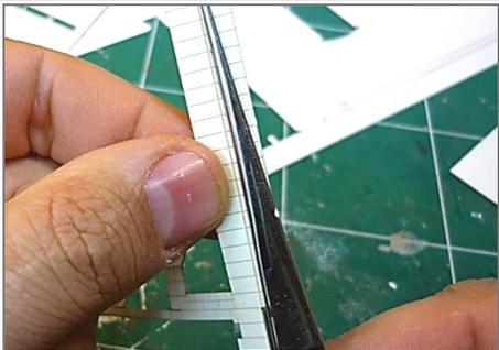
**4** Plier soigneusement à l'équerre les parements d'angles (angles de murs, jambages de portes et fenêtres...) à l'aide d'une pince brucelles ou d'un réglet.
