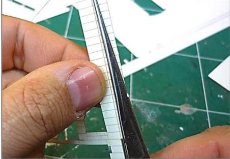
**4** Plier soigneusement à l'équerre les parements d'angles (angles de murs, jambages de portes et fenêtres...) à l'aide d'une pince brucelles ou d'un réglét.
