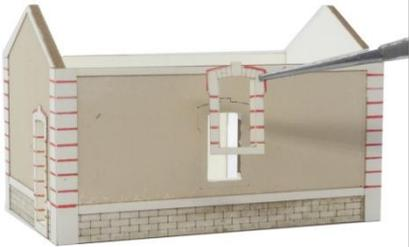
**4** Plier soigneusement à l'équerre les parements d'angles (angles de murs, jambages de portes et fenêtres...) à l'aide d'une pince brucelles ou d'un réglet. et les mettre en place
