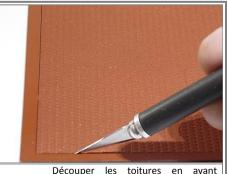
Découper les toitures en ayant marqué plus profondément au cutter la rainure centrale. Ici sera faite la pliure du faîtage.
