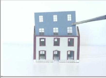
**8** Découper aux dimensions la feuille de plastique transparent des vitrages et appliquer sur la face intérieure (non gravée) des huisséries avec la colle à bois. Coller les ensembles obtenus depuis l'intérieur du bâtiment.
