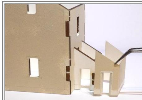
Encoller au pinceau les parements en évitant tout surplus (colle à bois). Mettre en place la finition de mur au niveau de l'appentis. Maintenir les différentes pièces pendant le séchage avec des élastiques ou des pincettes-étai par exemple.
