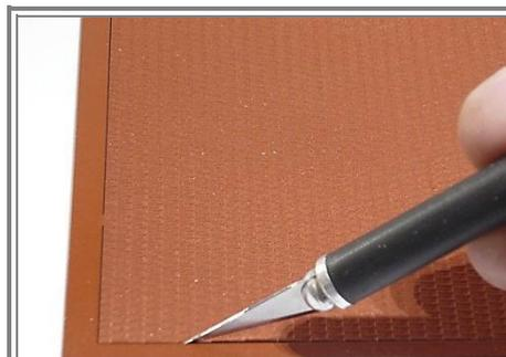
Découper les toitures en ayant marqué plus profondément au cutter la rainure centrale. Ici sera faite la pliure du faitage.
