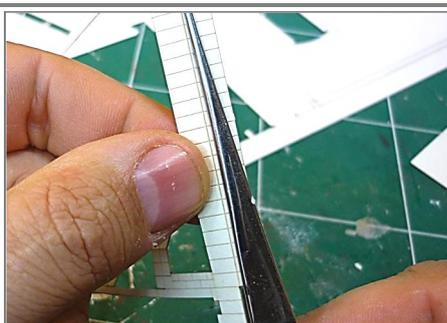
Plier soigneusement à l'équerre les parements d'angles (angles de murs, jambages de portes et fenêtres...) à l'aide d'une pince brucelles ou d'un règlet.
