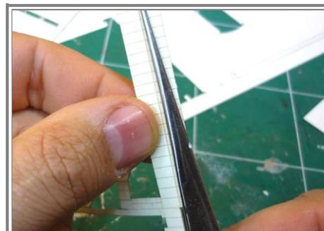
**6** Plier soigneusement à l'équerre les parements d'angles (angles de murs, jambages de portes et fenêtres...) à l'aide d'une pince brucelles ou d'un réglé.
