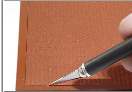
**9** Découper les toitures en ayant marqué plus profondément au cutter la rainure centrale. Ici sera faite la pliure du faîtage.
