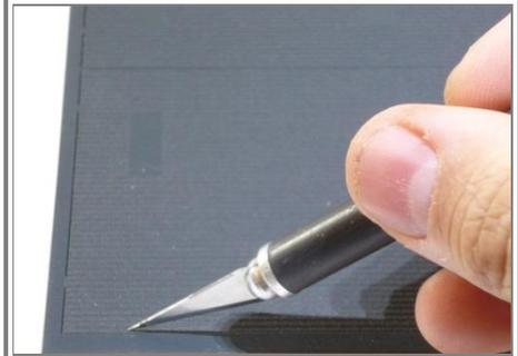
**9** Découper les toitures en ayant marqué plus profondément au cutter la rainure centrale. Ici sera faite la pliure du faitage.
